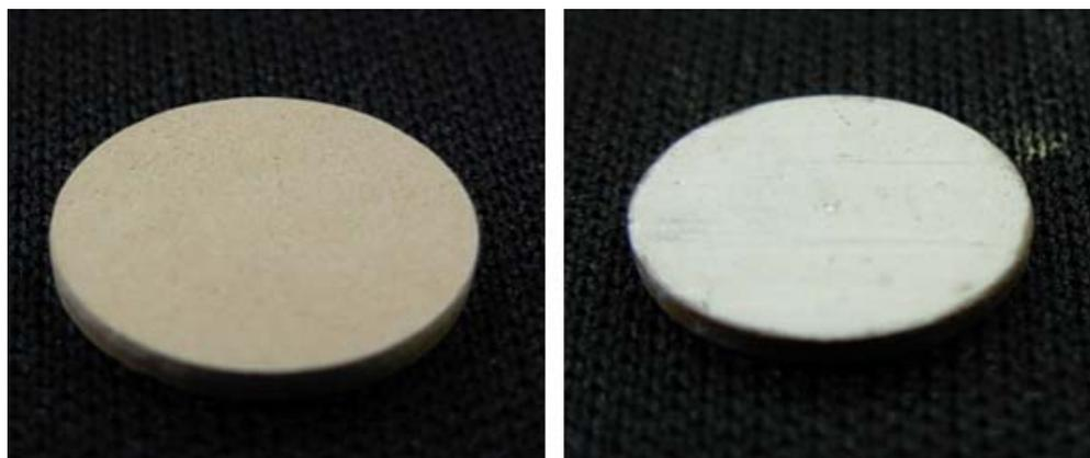
Figura 5.2 - Amostra queimada a 1000°C por 2h antes e após a deposição de tinta prata para as medições elétricas.
