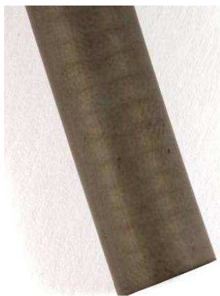
Figura 6.27 – Tubo produzido com o Feedstock PS+PEBD10 após a etapa de debinding .
