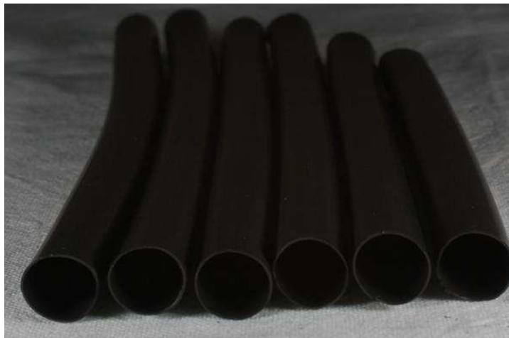
Figura 6.19 – Tubos produzidos com o feedstock PS+PEBD50 e extrudados a 150°C.
