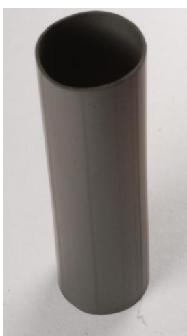
Figura 6.28 - Tubo produzido com o Feedstock PS+PEG20 após a etapa de debinding .
