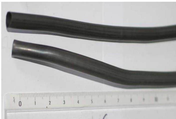
Figura 6.22 – Tubos preparados com o feedstock PS+PEG40 e extrudados a 135°C.
