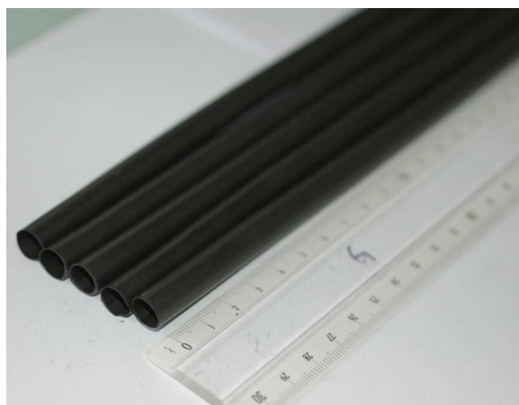
Figura 6.21 – Tubos produzidos com o feedstock PS+PEG20 e extrudados a 145°C
