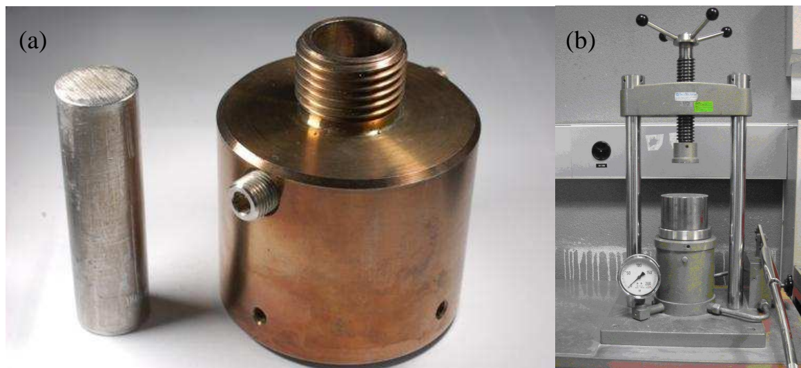
Figura 5.6 – Sistema de prensagem: matriz (a); prensa hidráulica uniaxial (b).
