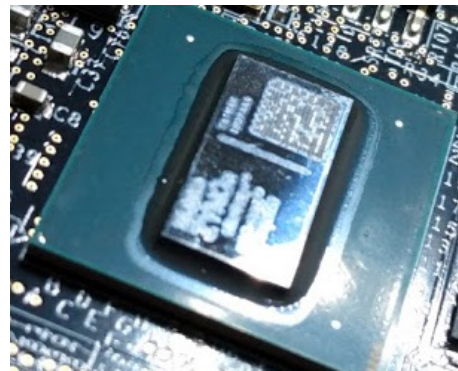
(d) Zynq UltraScale+ ZU3EG delidded flip-chip
