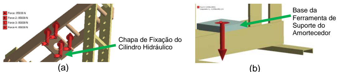
Figura 4.6 – Aplicação das cargas para análise do modelo CAD: parte móvel: 85,83 kN (a), base da ferramenta de suporte do trem de pouso: 345 kN (b).
