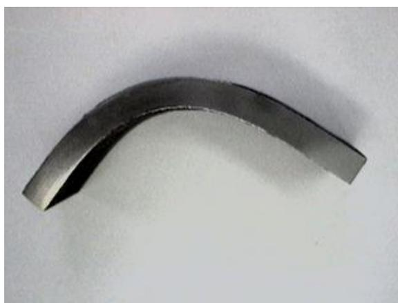
Figura 5 – Tira de aço deformado limitando o campo crítico da peça
