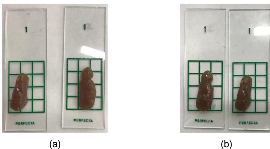
Figura 30. Adesivo de Protium heptaphyllum antes do ensaio de absorção de água (a) e após 8 horas submerso em água (b)
