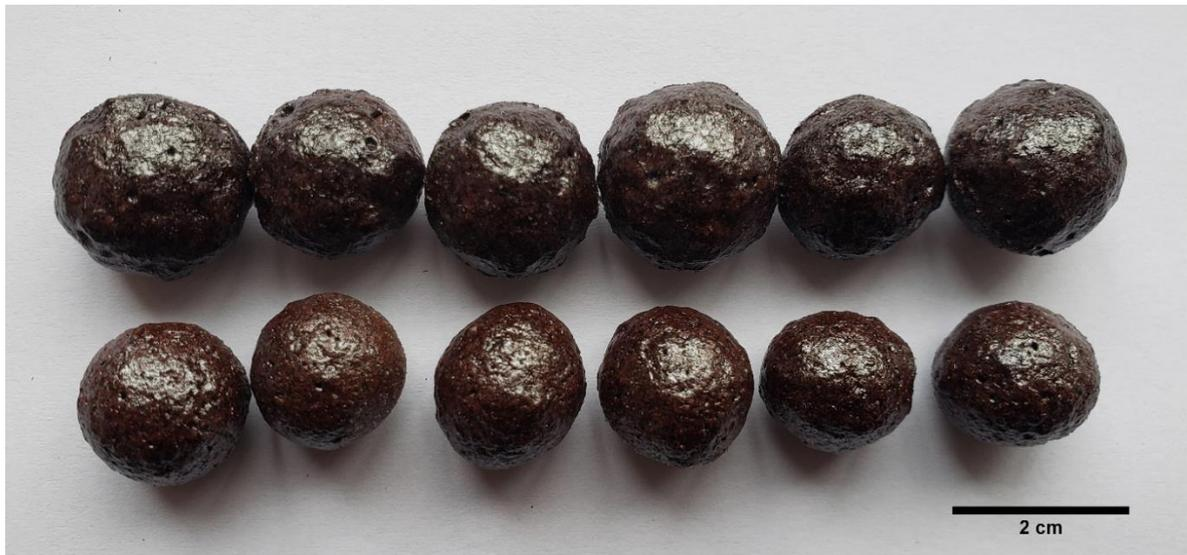
**Figura 31:** Agregados com 25% (fileira inferior) e 31% (fileira superior) de vidro após a queima a 1200 °C.
