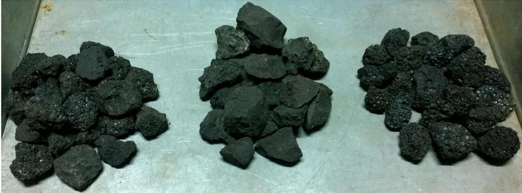
**Figura 10:** Escória de aço em diferentes formas (peso). **Fonte:** Mohammed *et al.*, 2016.
