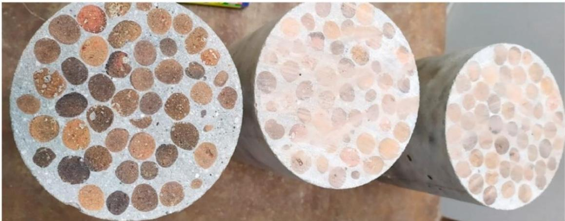
**Figura 19:** Concreto de agregado leve de cinzas de biomassa de dendê e silte. **Fonte:** Kwek *et al.*, 2022.
