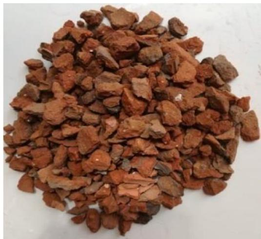
**Figura 5:** Agregados de tijolo triturado. **Fonte:** Atyia, Mahdy & Elrahman, 2021.
