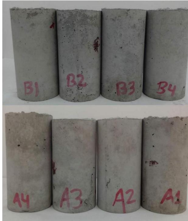
**Figura 42:** Corpos de prova obtidos com agregados G31 e S10-31. **Fonte:** o autor.
