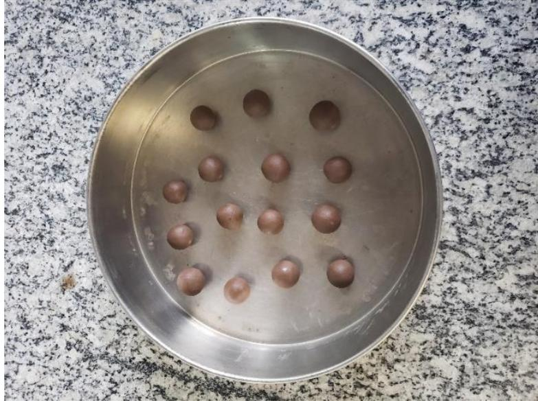
**Figura 28:** Agregados moldados antes de passarem pelo processo de queima. **Fonte:** o autor.
