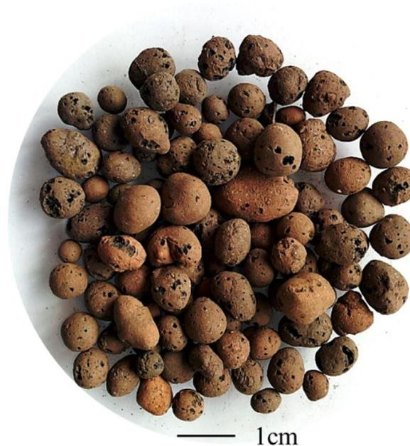
**Figura 6:** Agregados leves de argila expandida. **Fonte:** Ayati *et al.*, 2018.
