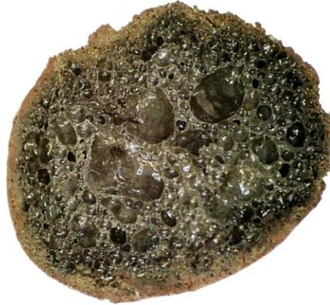
**Figura 9:** Seção transversal de um agregado queimado por 30 minutos, onde é possível observar a estrutura interna altamente porosa. **Fonte:** Moreno *et al.*, 2020a.
