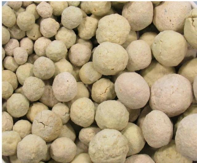
**Figura 14:** Agregados leves de lodo de esgoto tratado com cal e cinzas casca de dendê.
