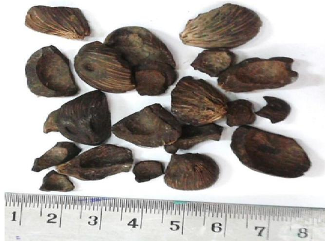
**Figura 4:** Agregados de casca de dendê. **Fonte:** Hamada *et al.*, 2020.
