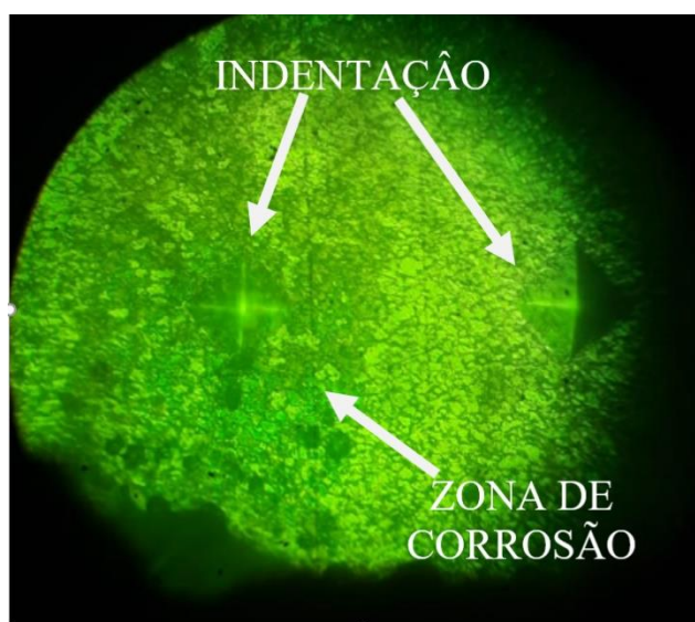
Figura 55 – Indentações de amostras de ferro puro exposta ao SBF
