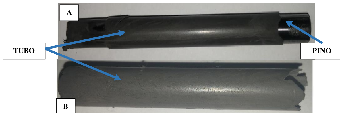
Figura 45 - Tubos injetados: A- Tubos moldados com cargas termoplásticas junto ao pino; B- Tubo desmoldado com sua extremidade quebrada.
