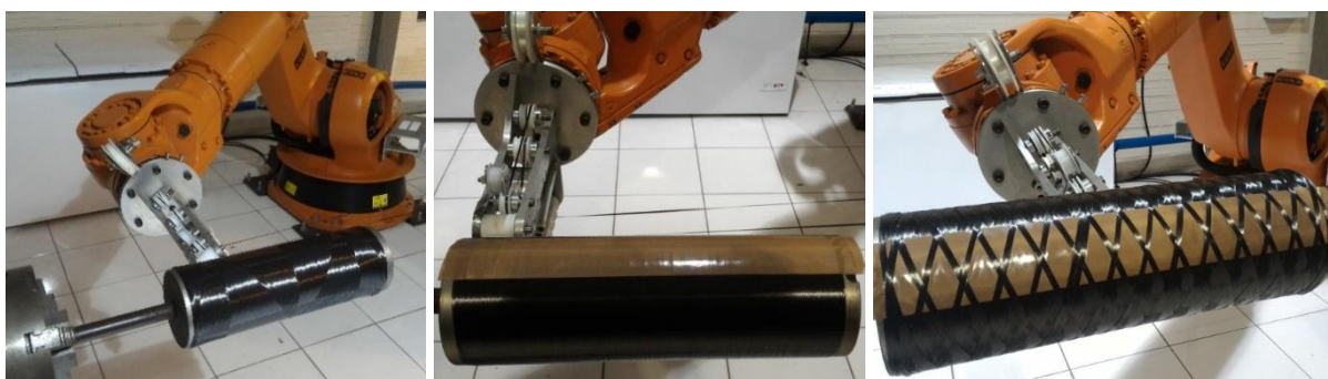
Figura 4.2 – Fabricação dos cilindros por enrolamento filamentar.
