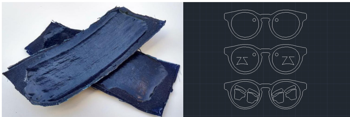
Figura 25 - Produção do material compósito em pré-forma e plano de corte
