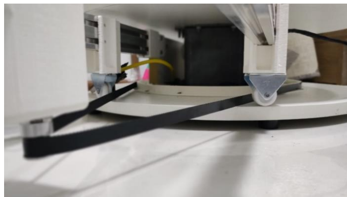
Figura 40 – Sistema de movimentação rotacional (foto 2)
