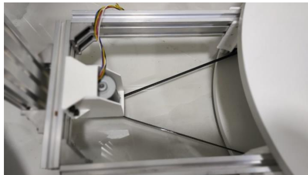
Figura 39 – Sistema de movimentação rotacional (foto 1)
