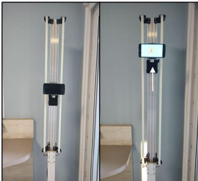
Figura 34 – Movimentação vertical do escâner, com amplitude de até 0,80m.
