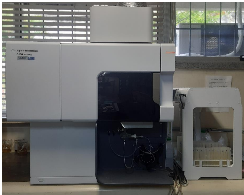
Figura 7: ICP-OES utilizado na análise das frações digeridas em água-régia, Agilent Technologies, modelo 5110.
