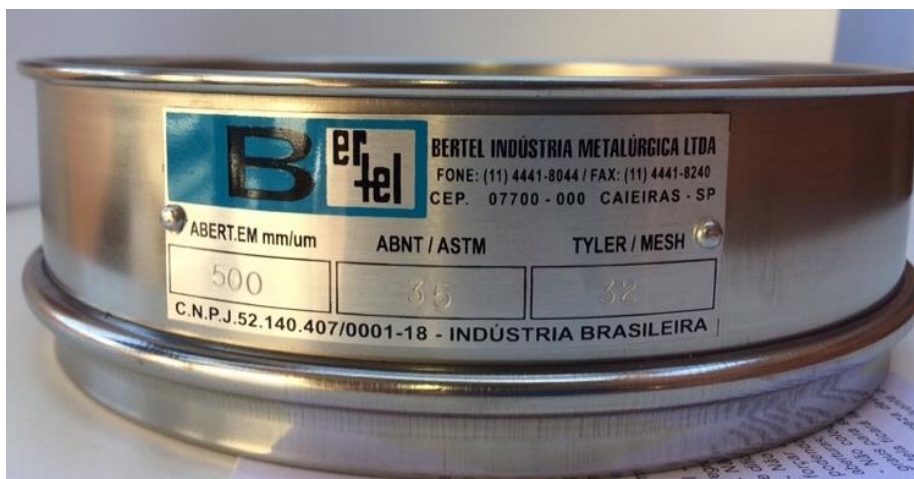
Figura 5: Peneira de 500 \mu\text{m} utilizada para etapa de separação granulométrica.
