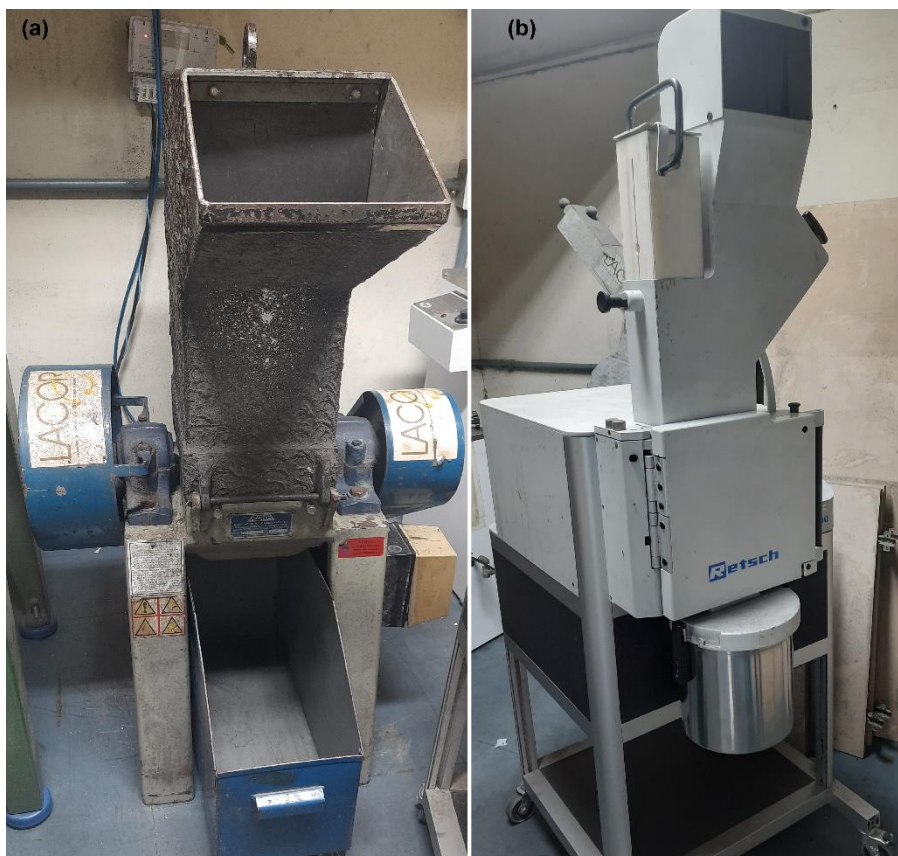
Figura 4: Moinhos (a) Rone e (b) Retsch utilizados durante a etapa de cominuição.
