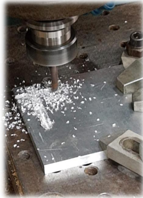
Figura 4.9 – Fresamento de dois canais perpendiculares nas peças quadradas.
