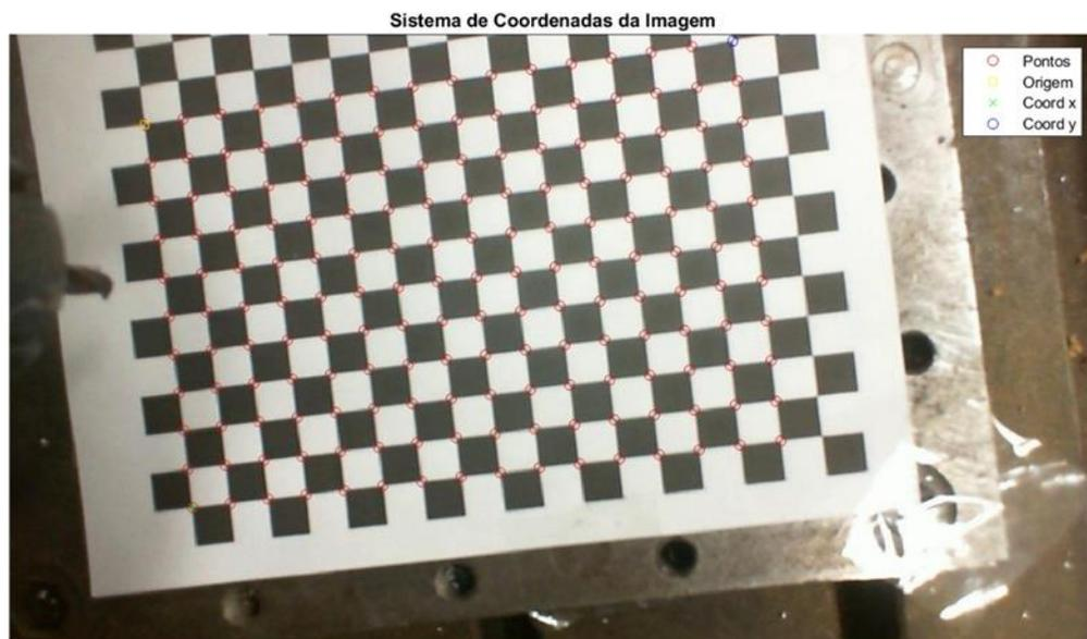
Figura 3.9 – Exemplo de identificação do sistema de coordenadas da imagem.
