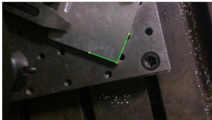
Figura 3.38 – Sistema de coordenadas da peça na imagem.
