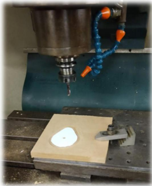
Figura 4.3 – Peça came fixada no centro de usinagem CNC.
