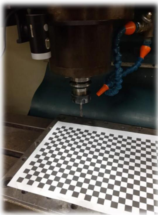
Figura 4.2 – Posicionamento da câmera e padrão xadrez para obtenção dos parâmetros extrínsecos.
