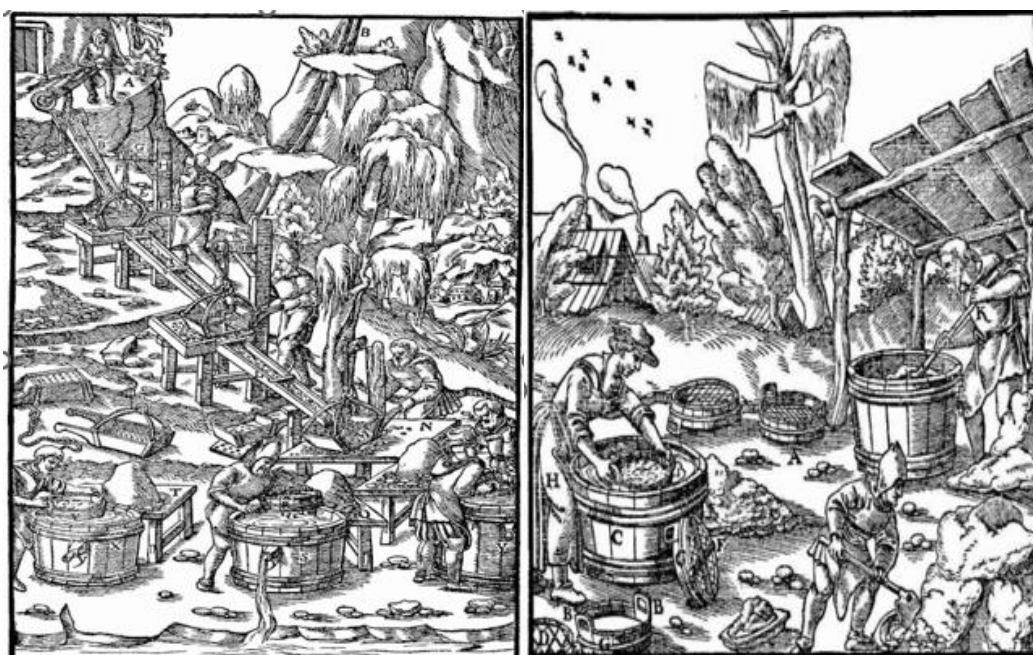
Figura 1-Estágios de concentração mineral do primeiro registro do uso método de jigagem
