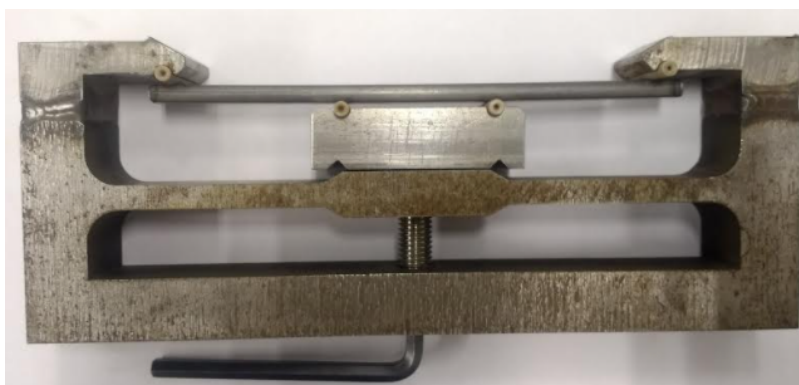
Figura 34 – Montagem da amostra em dispositivo de flexão em quatro pontos.
