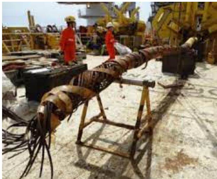
Figura 15 – Aspecto da AT de DF que apresnetou falha por SCC-CO 2 .
