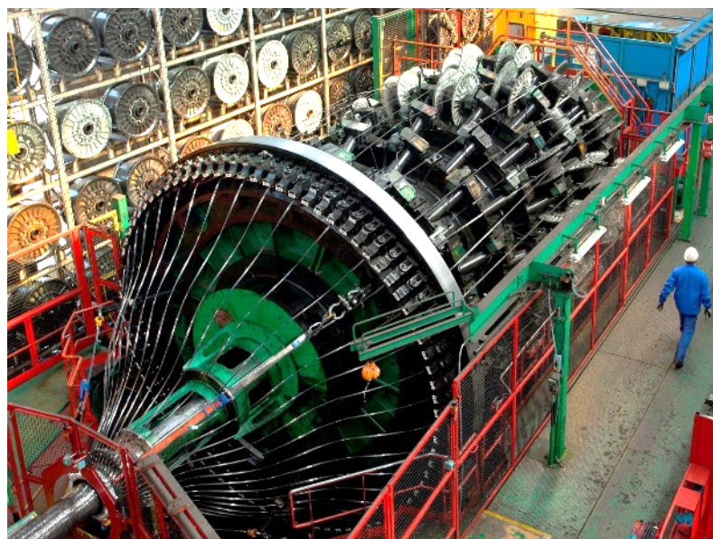
Figura 3 – Exemplo de uma máquina armadora durante a montagem da armadura de tração.
