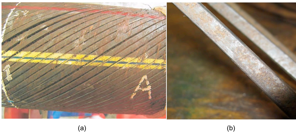
Figura 10 – Armadura de tração: (a) AT de DF e (b) arames da AT individuais.
