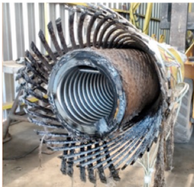
Figura 5 – Retorno elástico da armadura de tração de um dutos flexível durante a dissecação.
