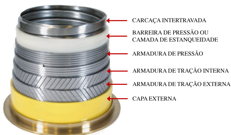
Figura 2 – Configuração típica de um dutos flexíveis unbonded .
