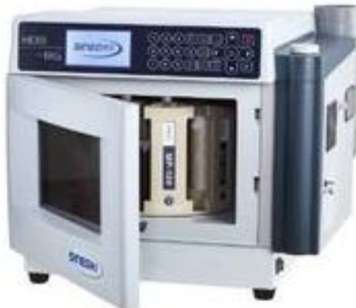
Figura 12 - Aparelho de microondas utilizado na síntese para obtenção de óxido de zinco dopado com gálio.
