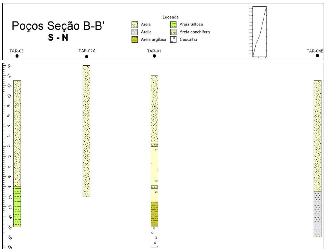
Figura 30. Seção B-B' elaborada a partir do software Strater 5 com detalhe maior para o SAC, onde é possível observar a relação das camadas entre os poços, com a base da porção arenosa em correlação.
