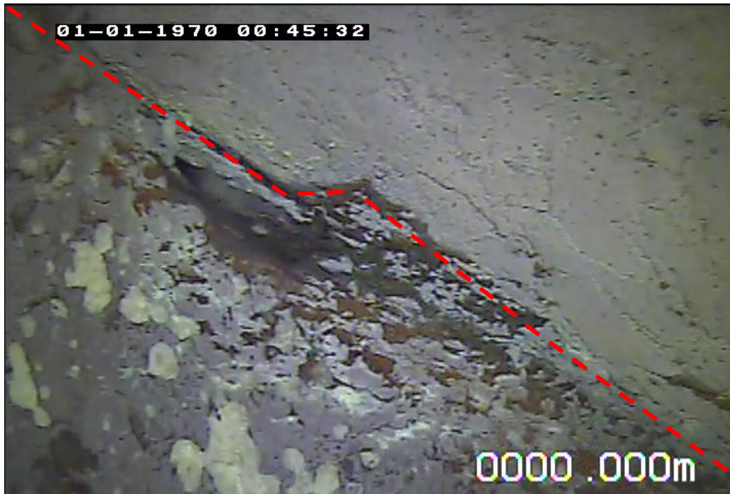
Figura 19. Detalhe para interface basalto-arenito, do poço TAR-12, onde o arenito intertrápico (porção superior) transiciona para o basalto amigdalóide com entrada d'água presente.
