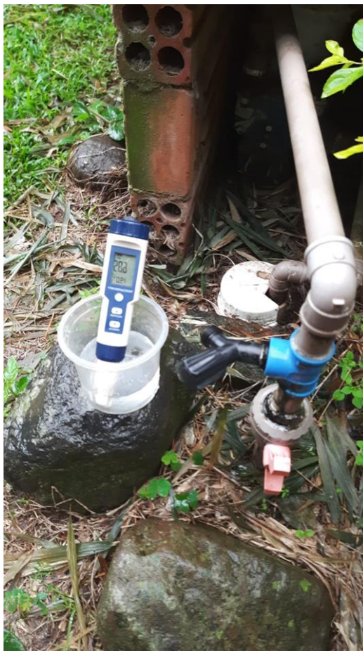
Figura 12. Análise de água utilizando a sonda multiparâmetros modelo KkCare.
