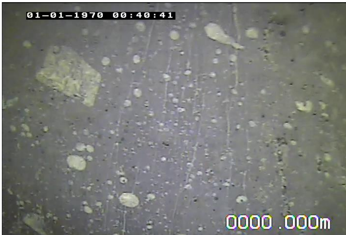
Figura 16. Zona de vesículas e amígdalas em basalto acinzentado, correspondendo a provável porção central do derrame, além de pequenos veios também presentes no poço TAR-12.
