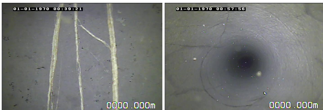
Figura 17. Zona onde predominam fraturas e veios, além de pequenas vesículas à esquerda, também no poço TAR-12.
