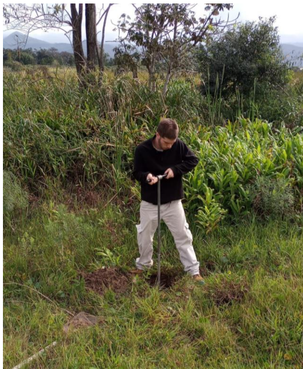
Figura 25. Escavação por meio de trado manual em depressão topográfica, correspondente aos depósitos de turfeira.
