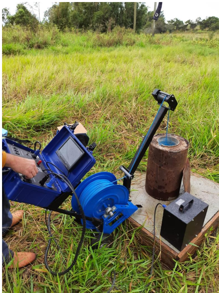
Figura 11. Imageamento do poço COR TAR 12 com o uso da câmera LAVAL R-CAM 1000.
