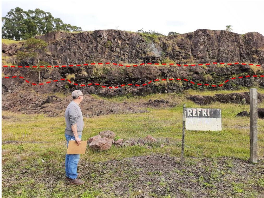
Figura 15. Derrames de lava basáltica em área de empréstimo, detalhe para os derrames individualizados em vermelho.
