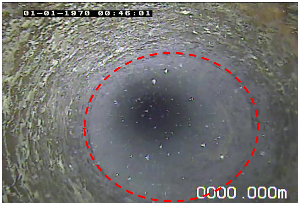
Figura 20. Detalhe para interface basalto-arenito, do poço TAR-12, onde o arenito intertrápico (porção superior) transiciona para o basalto, sendo aqui sua porção basal.
