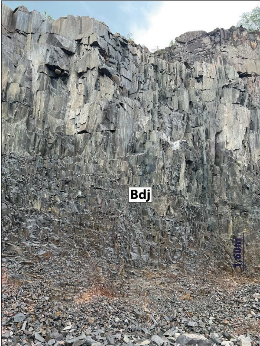
Figura 31 - Basalto com disjunções colunares (Bdj) típicas de intrusão na Pedreira São Joaquim (Fonte: do autor).
