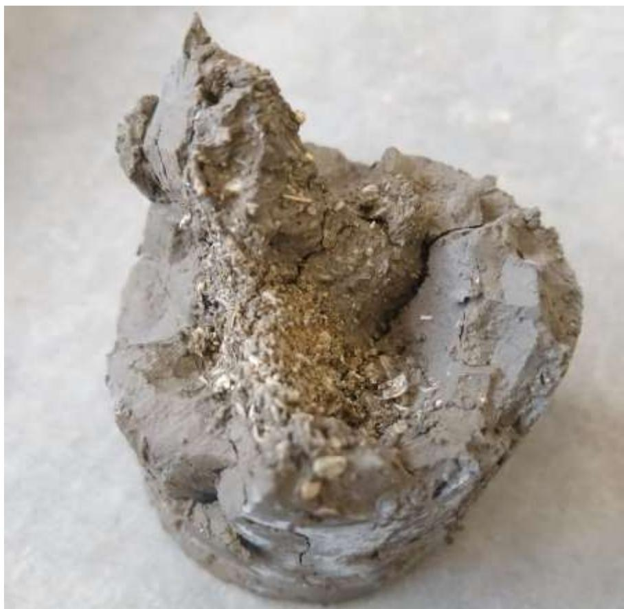
Figura 3.4 – Amostra de solo argiloso *offshore* com presença de detritos de invertebrados
