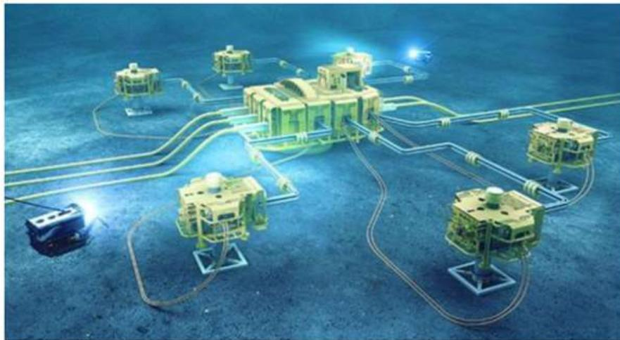
Figura 2.6 – *Manifold*, em funcionamento, conectado a seis poços de exploração (Silva, 2015 *apud* Faria, 2019)
