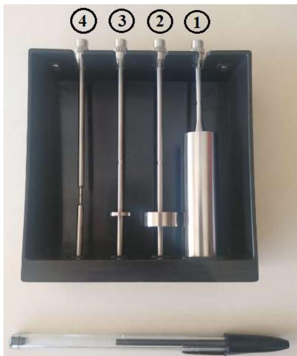
Figura 3.17 – Numeração dos rotores do Viscosímetro utilizado
