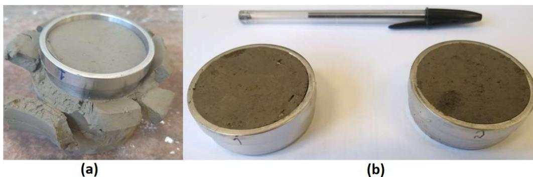
Figura 3.12 – (a) moldagem da amostra de solo *offshore* e (b) amostras já preparadas para a realização do ensaio
