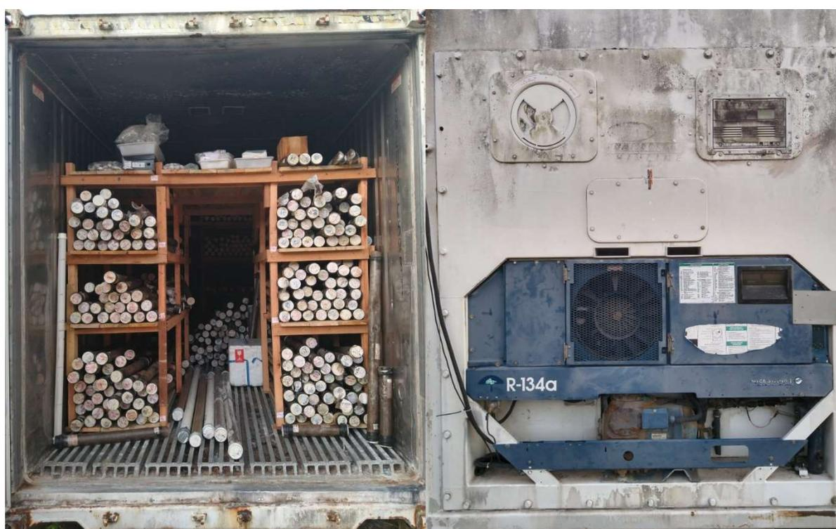
Figura 3.2 – Armazenamento dos testemunhos em um contêiner com sistema de refrigeração
