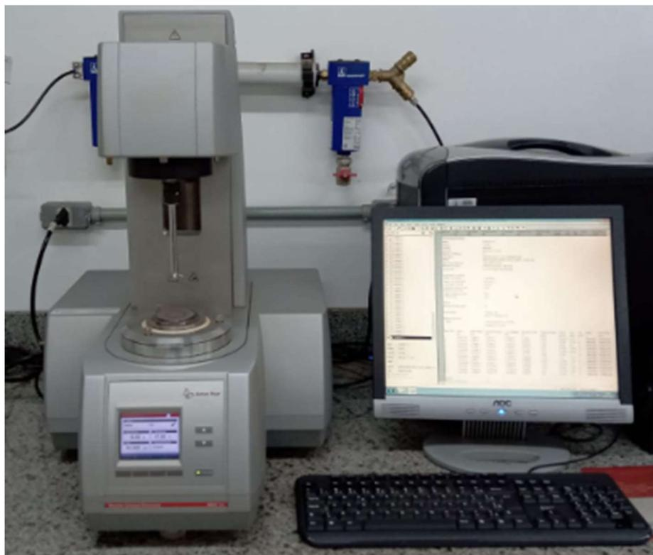
Figura 3.20 – Reômetro modular compacto MCR 101 da UFSM
