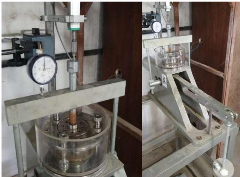
Figura 3.11 – Ensaio de compressão oedométrica em andamento
