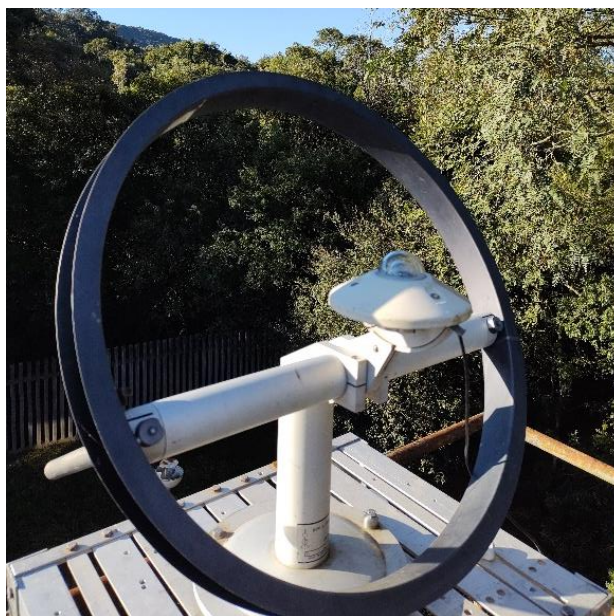
Figura 3.7 – Piranômetro equipado com anel de sombreamento acoplado para realizar medição de irradiação solar difusa no plano horizontal
