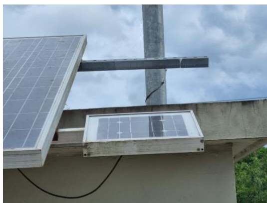
Figura 3.8 - Célula de referência utilizada no LABSOL para medição da irradiância solar global no plano inclinado dos módulos
