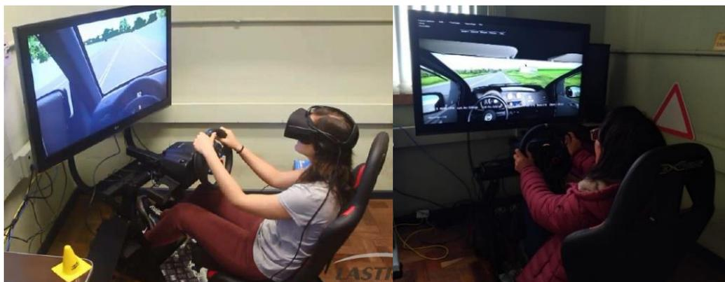
**Figura 1:** Simulador de direção com HMD (esquerda) e com tela plana (direita).
