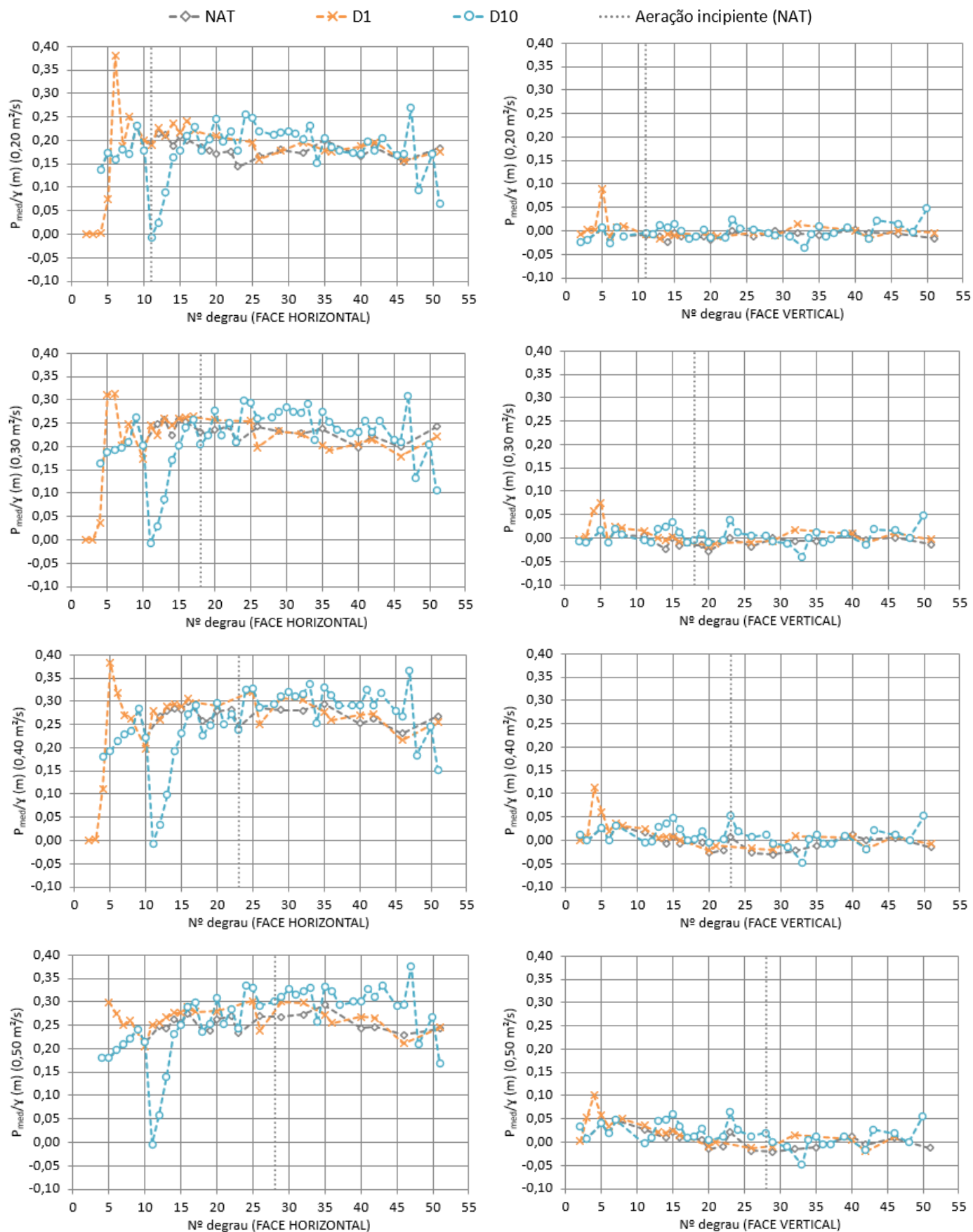
Figura 16.1 – Parâmetro P_{med}/\gamma (representado em unidade de altura piezométrica, em m), ao longo dos degraus, para as condições NAT, D 1 e D 10 , considerando 0,20 \text{ m}^2/\text{s} \leq q \leq 0,50 \text{ m}^2/\text{s} (de modo que cada linha de gráficos apresenta os resultados associados a uma mesma vazão q , como indicado). Os resultados obtidos na face horizontal estão representados à esquerda e os na face vertical à direita.
