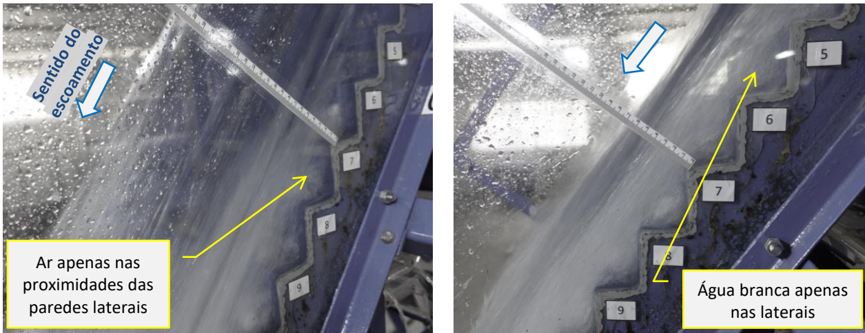
a) Efeitos de parede ("falso" início de aeração)
