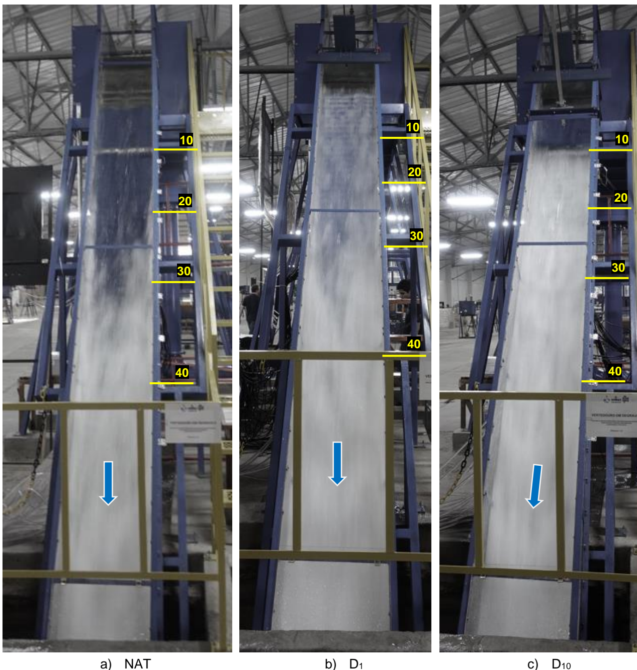
Figura 5.9 – Fotografias do escoamento, em vista frontal, nas condições a) NAT, b) D_1 e c) D_{10} , q = 0,40 \text{ m}^2/\text{s} . Os números em destaque representam os números dos degraus.
