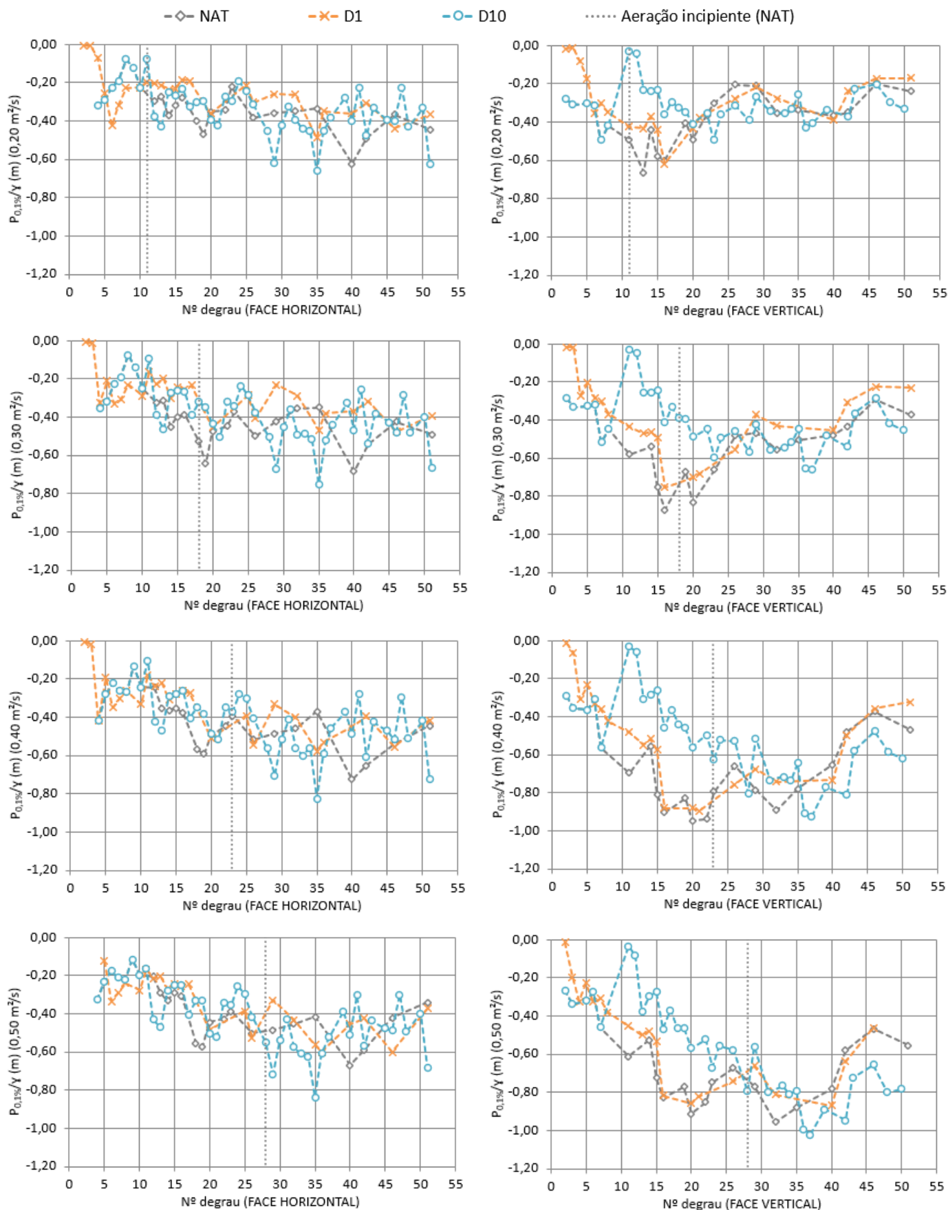
Figura 16.3 – Parâmetro P_{0,1\%}/\gamma (representado em unidade de altura piezométrica, em m), ao longo dos degraus, para as condições NAT, D 1 e D 10 , considerando 0,20 \text{ m}^2/\text{s} \leq q \leq 0,50 \text{ m}^2/\text{s} (de modo que cada linha de gráficos apresenta os resultados associados a uma mesma vazão q , como indicado). Os resultados obtidos na face horizontal estão representados à esquerda e os na face vertical à direita.
