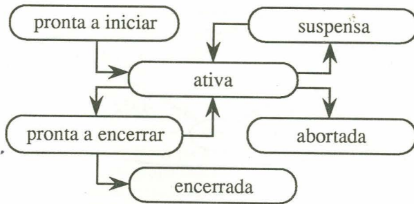
Figura 8: Conjunto de estados e transições possíveis para transações de projeto em MG3
