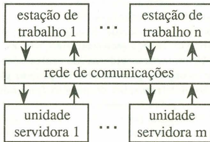
Figura 2: Arquitetura de um sistema de CAD moderno
