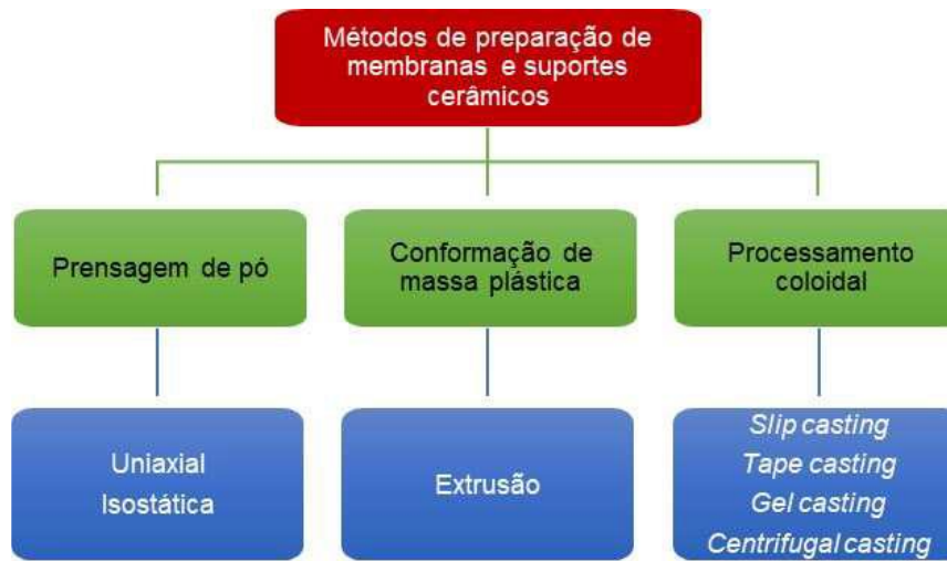
Figura 6: Principais técnicas de preparação de membranas e suportes cerâmicos.
