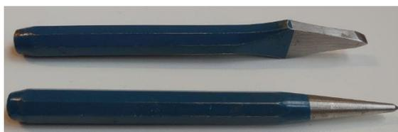
Figura 21: Ferramentas utilizadas para quebrar o sal ao redor da amostra.
