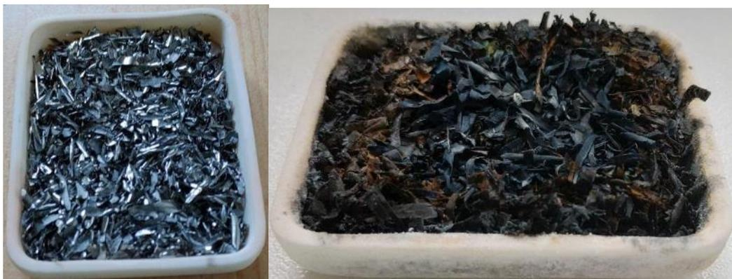
Figura 8: Cadinho com Ti no fundo do reator, antes e depois do experimento.
