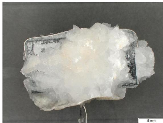
Figura 28: Amostras após ter sido removida da mistura de sais.
