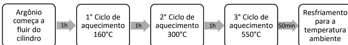
Figura 11: Ciclo de aquecimento utilizado para a homogeneização das misturas de sais.
