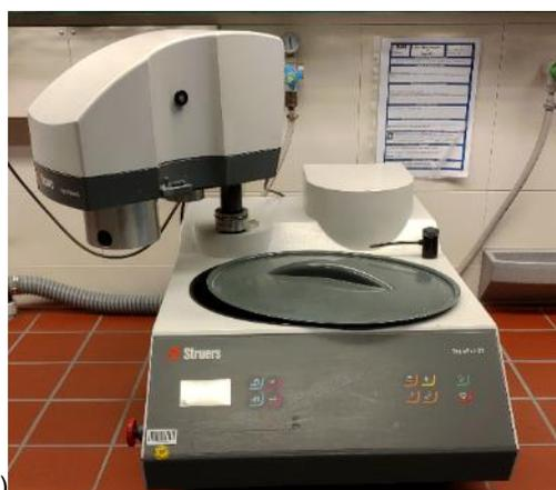
a) b) Figura 22: a) Equipamento utilizado para cortar as amostras; b) Equipamento utilizado para lixar e polir as amostras.
