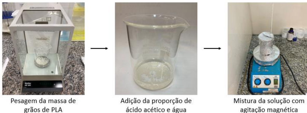
Figura 3: Procedimento experimental adotado para os testes de solubilização do PLA com ácido acético.
