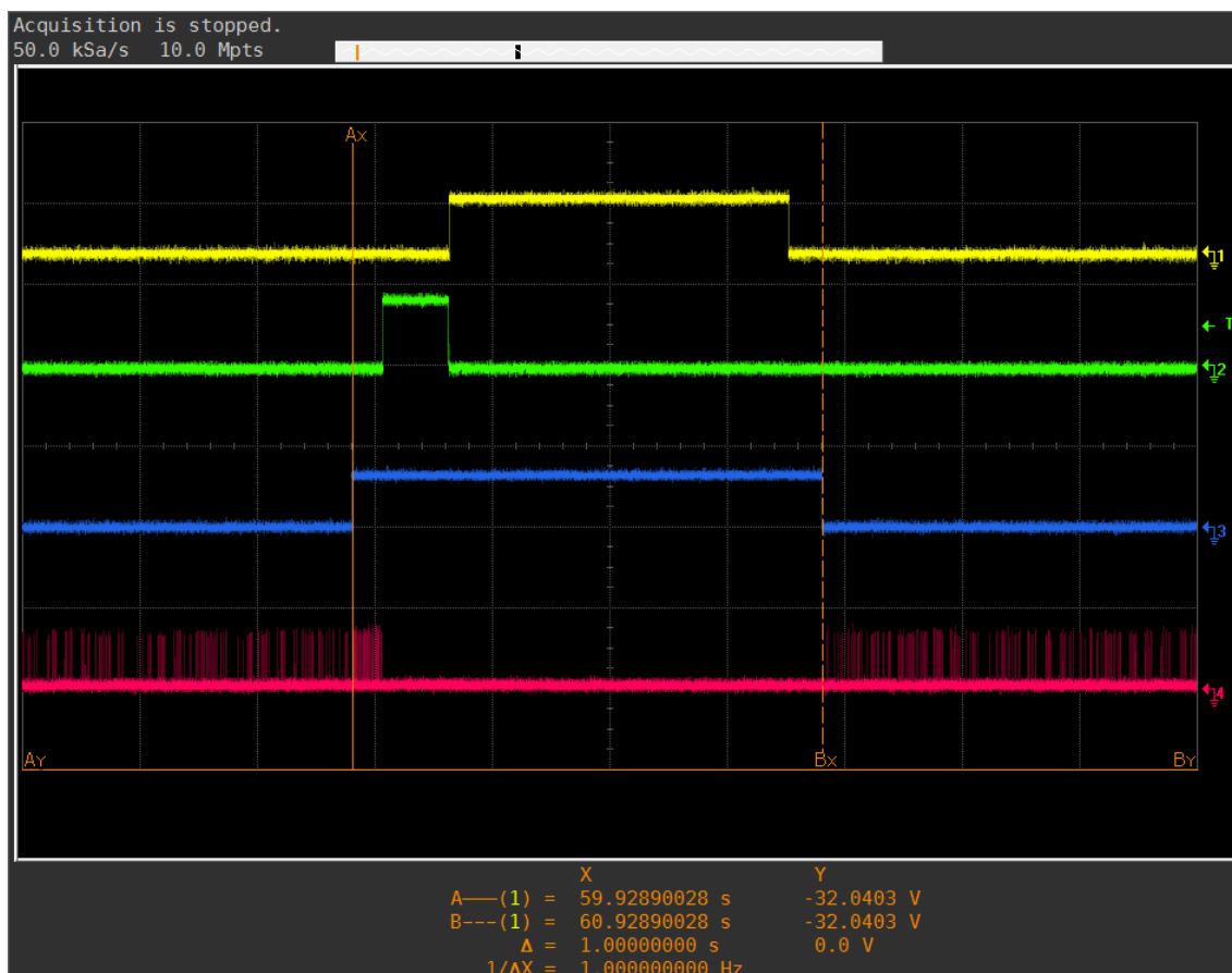
Figura 26: Medição RTC do nodo coletor (Canal 3) relacionado ao segundo ADV do primeiro ensaio de verificação da correção de offset .
