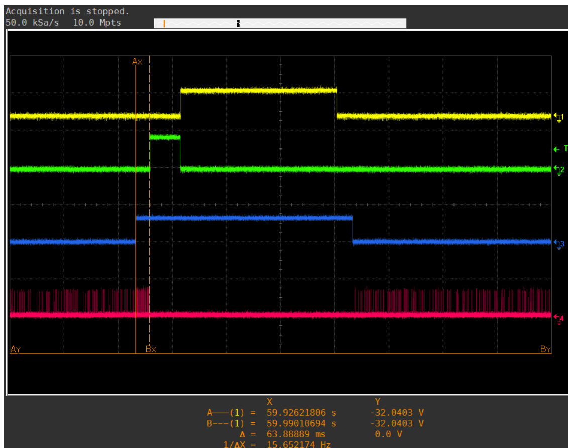
Figura 30: Medição SCLK da comunicação SPI do módulo LoRa (Canal 4) relacionado ao segundo ADV do primeiro ensaio de verificação da correção de offset .
