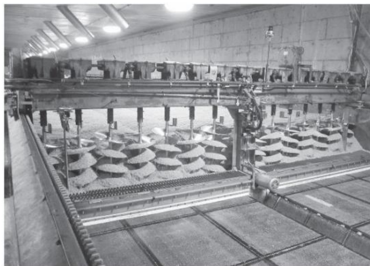
Figura 4. Compartimento retangular de germinação com máquina de revolvimento.
