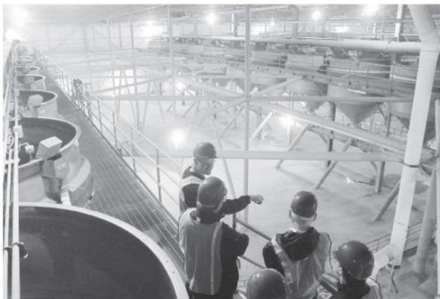
Figura 3. Tanques cilíndrico-cônicos de maceração em uma malteria.
