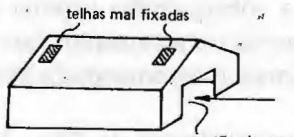
h) Telhas mal fixadas portão aberto acidentalmente
