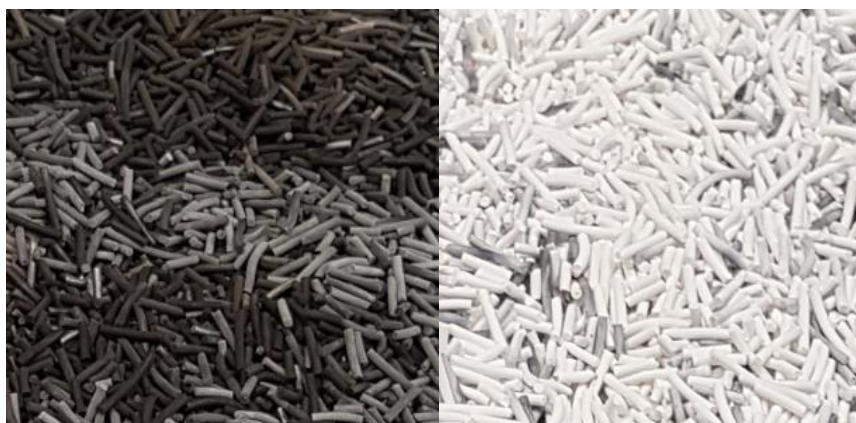
Figura 22: Zeólita tipo ZSM-5 com depósito de coque (à esquerda) e após regeneração por queima (à direita)
