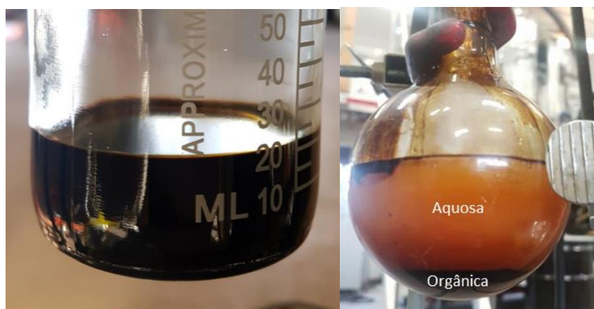
Figura 11: Bio-óleo de pirólise rápida monofásico (esquerda) e bio-óleo de pirólise rápida a 700°C separado em fração aquosa superior e orgânica inferior (direita).
