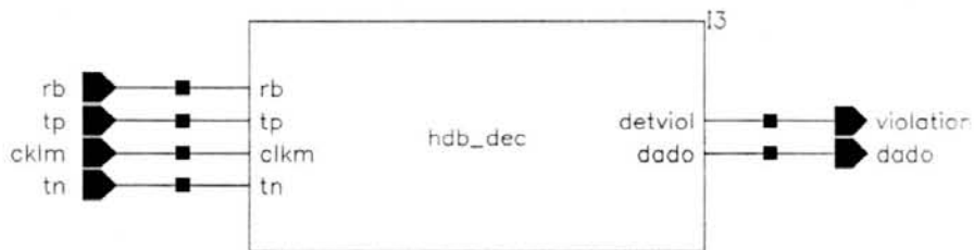
Figura 5.31 - Módulo de decodificação HDB-3 .
