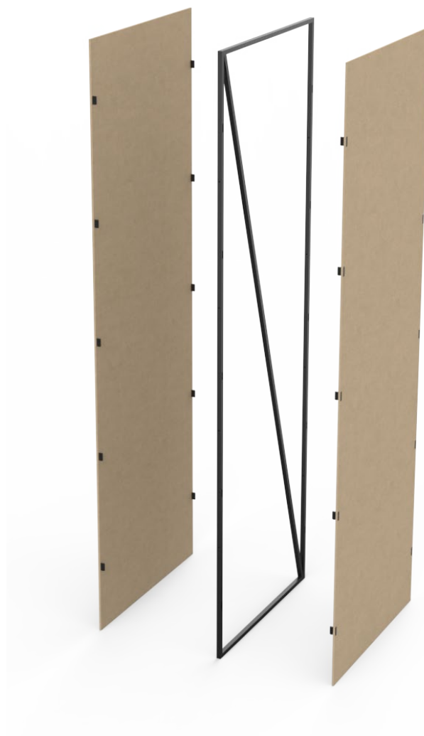
Figura 75 – Elementos do painel.
