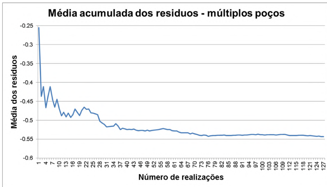
Figura 20 Média acumulada dos resíduos de cargas, no cenário de múltiplos poços operando simultaneamente.
