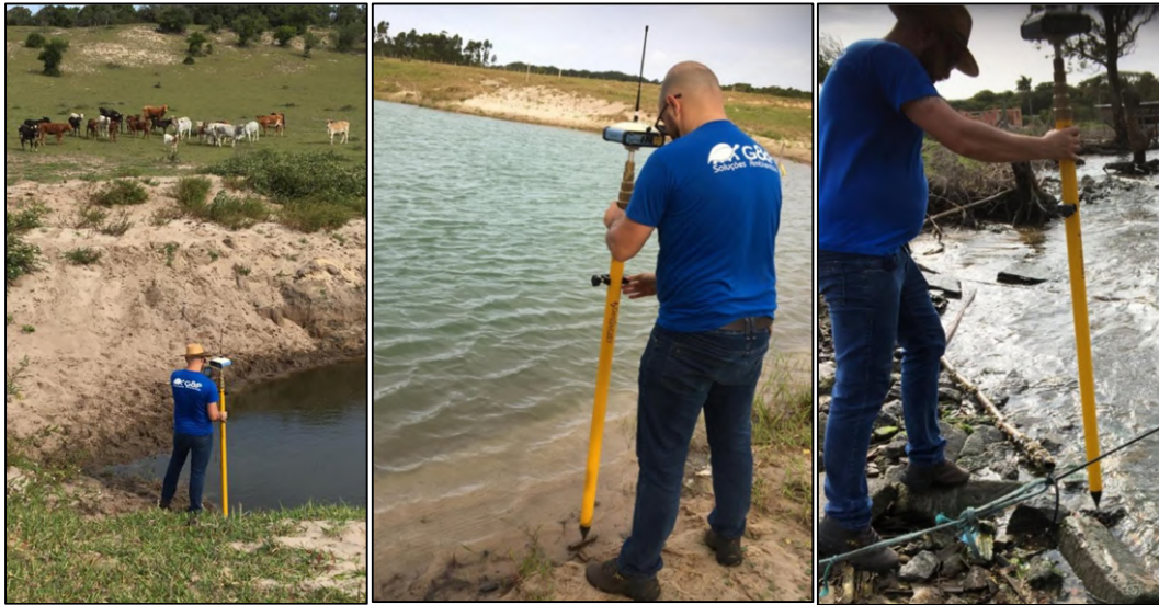
Figura 4 Campanha de campo com o uso do GPS sistema GNSS S86T RTK, para coleta das cargas hidráulicas dos corpos d'água superficiais.
