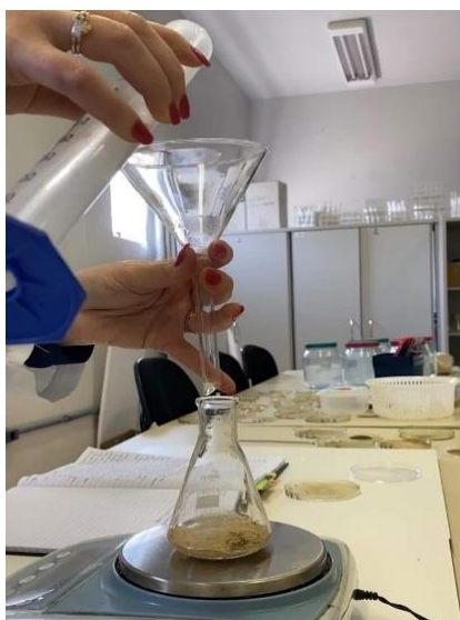
Fotografia 7 - Equipamentos usados: (1) Erlenmeyer, (1) funil de vidro, (1) proveta e (1) balança digital e (2) placas de petri.
