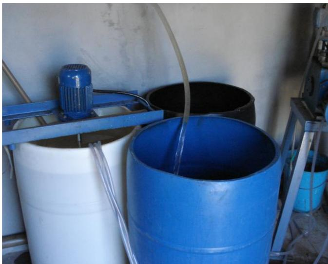
**Figura 5.4:** Preparação do polímero de forma manual e mecanizada.
