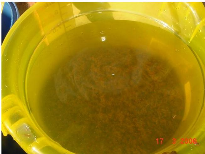
**Figura 5.3:** Reação do polímero com o lodo promovendo a separação da fase sólida da fase líquida
