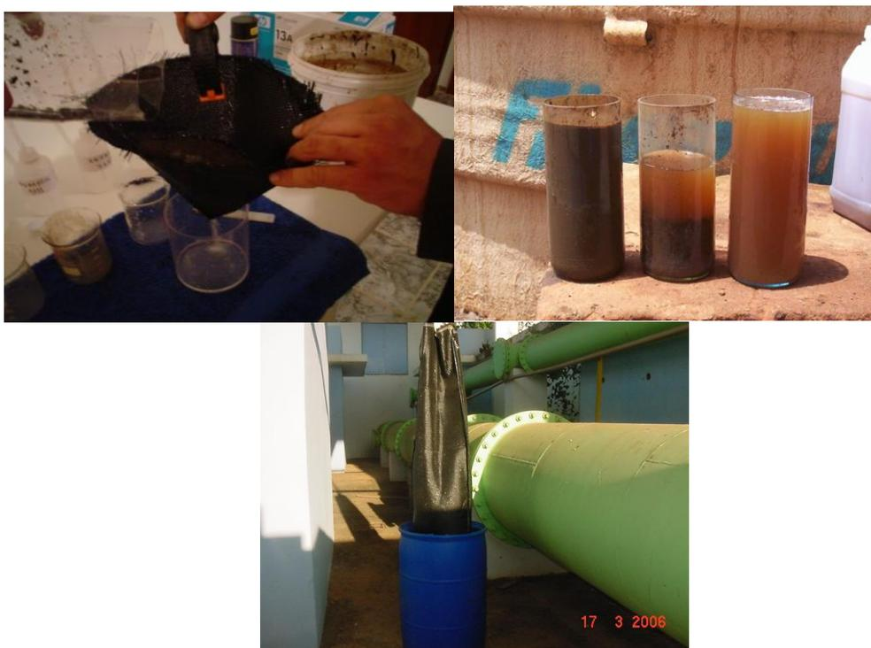
**Figura 5.6:** Seqüência do procedimento de ensaio. Foto (a) verificação, em bancada, da eficiência da filtração; Foto (b) verificação, *in loco*, da eficiência da floculação; Foto (c) suspender o *Bag* e deixar um tanque para o deságüe.
