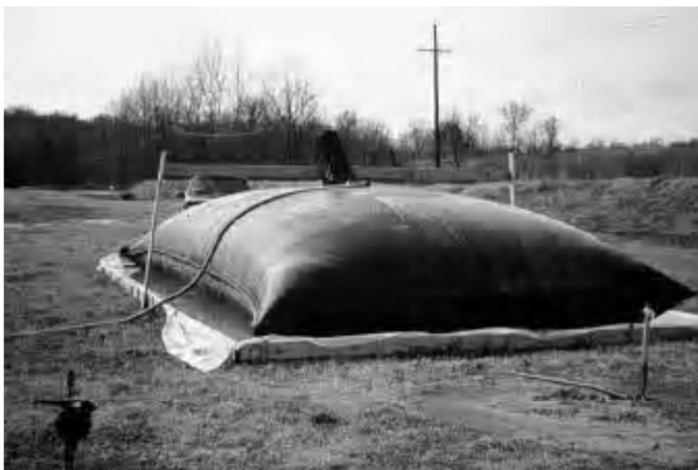
**Figura 2.12** : Tubo experimental preenchido até 1,5 m (Fowler et al 2002).
