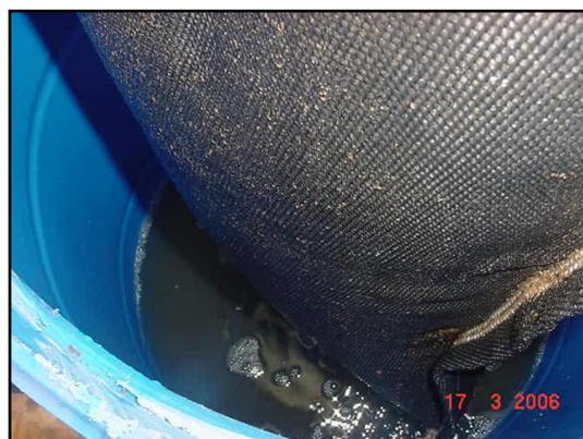
**Figura 3.3:** Deságüe no teste do bag suspenso
