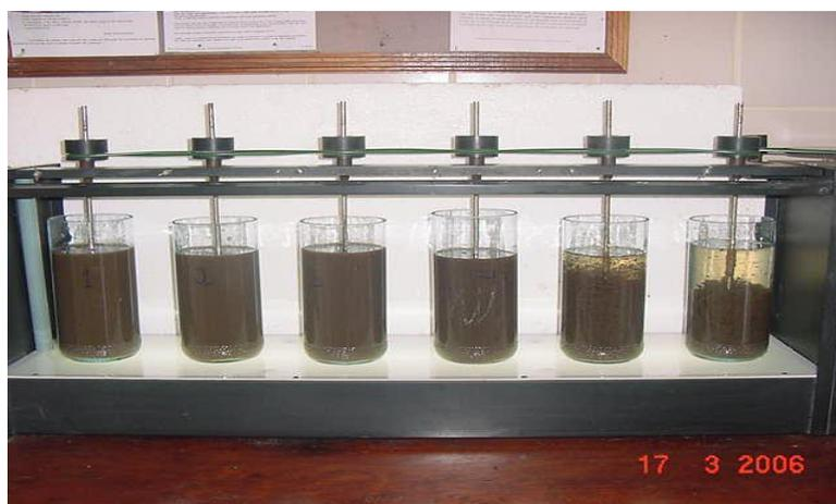
**Figura 5.2:** Ensaio, em bancada, com polímeros sintéticos.
