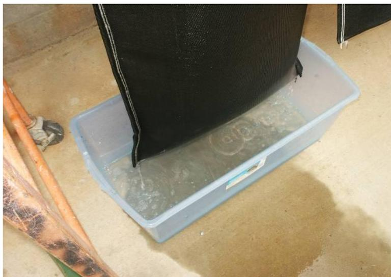
**Figura 5.7:** Detalhamento do processo de desaguamento
