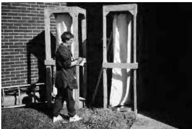
**Figura 2.13:** Ensaio com tubo suspenso.
