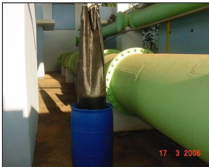
**Figura 3.1:** Teste do *bag* suspenso
