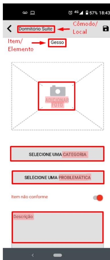
Figura 8: Realização de apontamento de defeito
