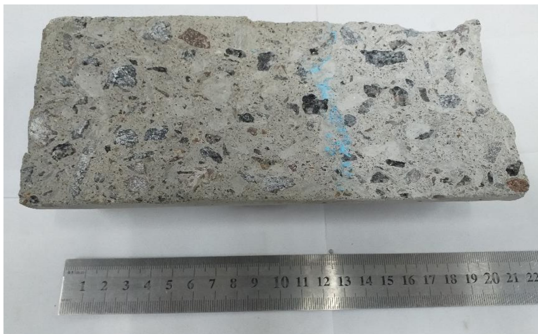
Figura 10 - Imagem fotográfica indicando a altura de água percolada no interior do corpo-de-prova após o ensaio de absorção de água por capilaridade (amostra contendo 0% de cinzas leves).
