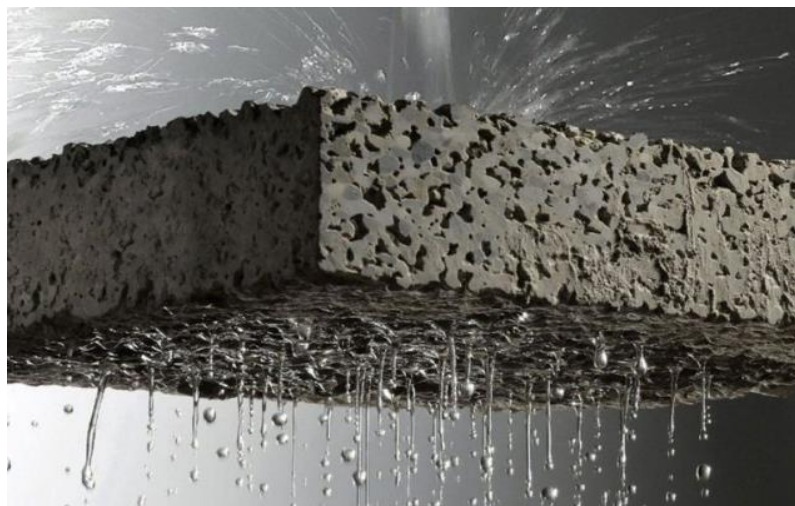
Figura 2 - Imagem ilustrativa de estrutura de concreto permeável.
