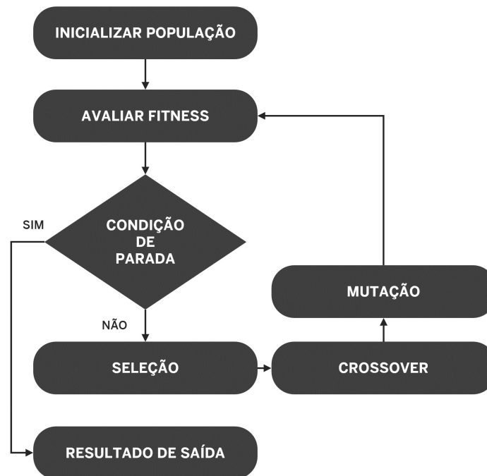
Figura 2.3 – Fluxograma básico de um algoritmo genético
