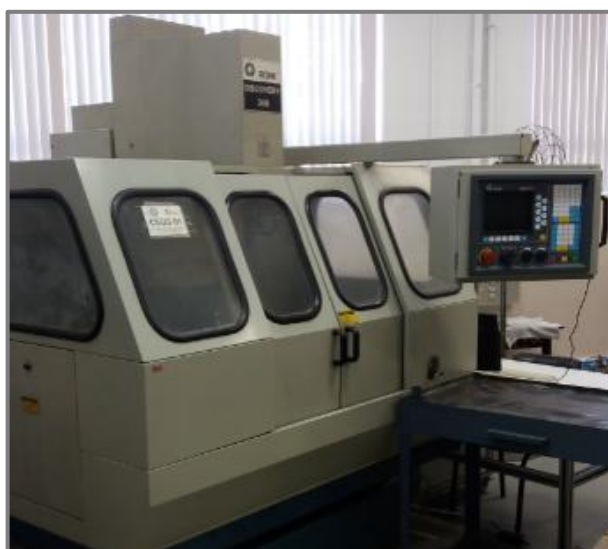
Figura 3.2 – Centro de Usinagem Romi Discovery 308.
