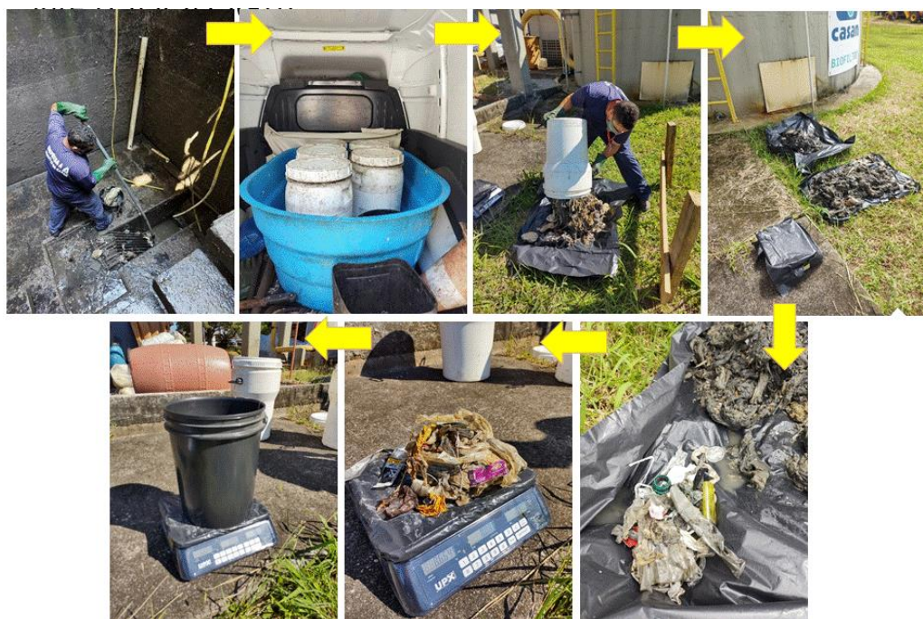
Figura 3.- Composição de imagens para exemplificação das principais etapas do estudo gravimétrico realizado.
