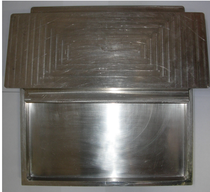
Figura 12: Molde em aço inox - cavidade interna de 270 \times 170 \times 22 mm – denominado Molde 2 .
