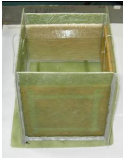
Figura 7: Aparato construído de material composto, utilizado para a produção de mantas de fibras vegetais.
