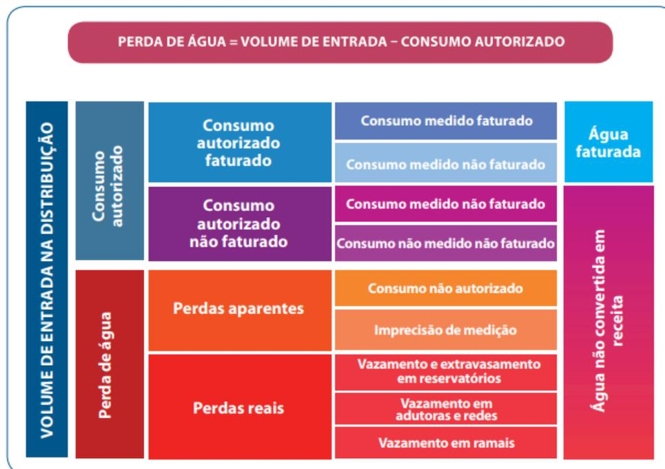
Figura 3.14. Definições acerca do assunto de perdas de água – Balanço hídrico da IWA. (Fonte: IWA, 2007.)
