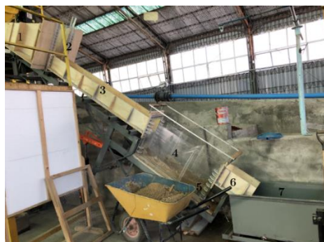
Figura 1. - Canal experimental. (1) Estanque de entrada. (2) Compuerta para controlar flujo. (3) Sección de lecho fijo. (4) Sección de lecho móvil. (5) Desagüe. (6) Sección final del Canal. (7) Estanque de Salida.
