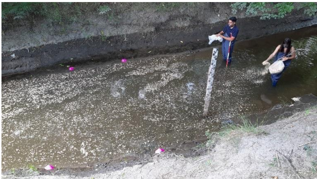
Figura 4. - Puntos fijos de referencia y sembrado de trazadores.
