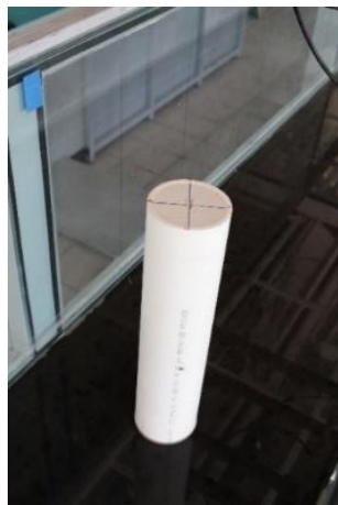
Figura 1. - Cilindro para generar la calle de vórtices de von Kármán.
