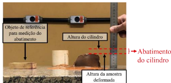
Figura 6. - Processo de medição do abatimento da amostra
