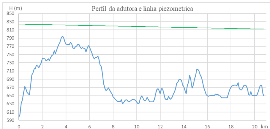
Figura 2- Perfil e linha piezométrica Trecho A1-B1 SARPCJ (fonte: Elaboração Própria)
