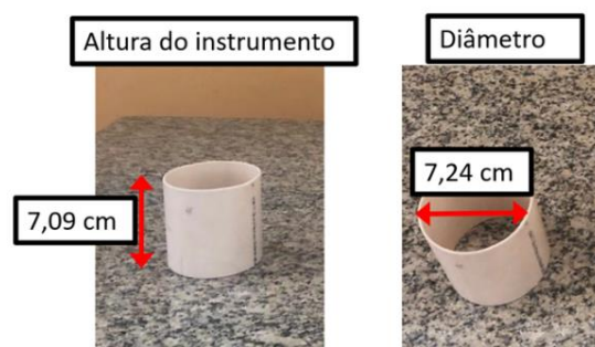
Figura 8. - Aparato cilíndrico utilizado nos testes de slump
