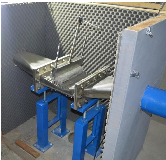
Figura 6.- a) e b) Dispositivo de cavitação instalado no LOH/UFRGS.
