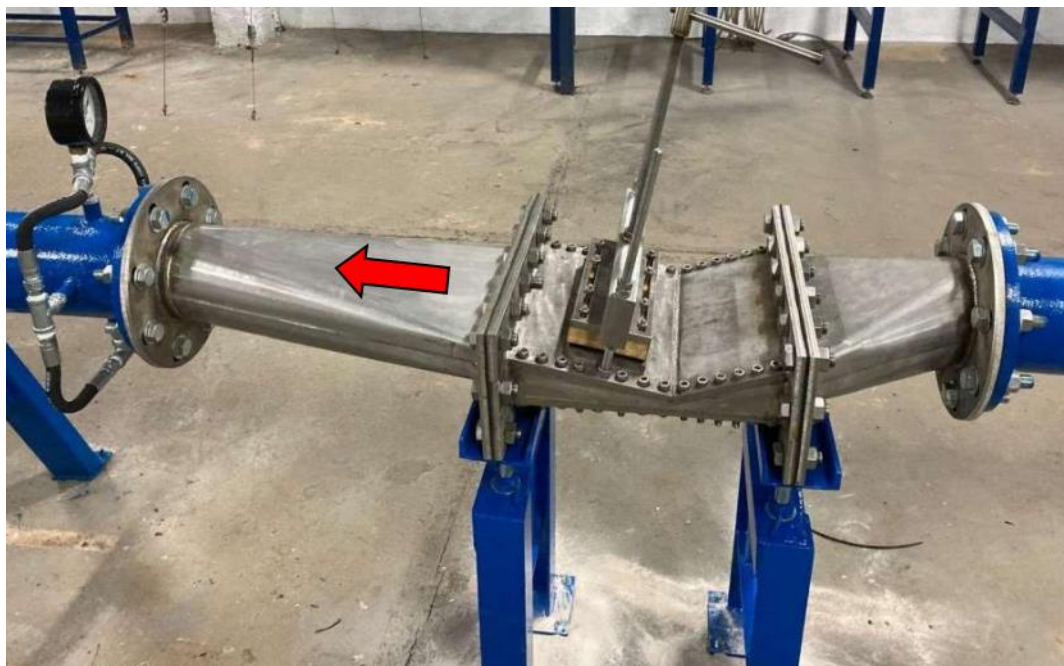
Figura 5.- Dispositivo de cavitação instalado no LOH/UFRGS, a seta vermelha indica o sentido do escoamento.
