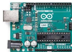
Figura 1 - Microcontrolador Arduino Arduino Uno Rev3. Fonte: https://store-usa.arduino.cc/products/arduino-uno-rev3?selectedStore=us
