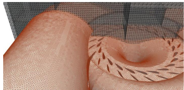
Figura 4.- Conexão da malha Lagrangiana e Euleriana.
