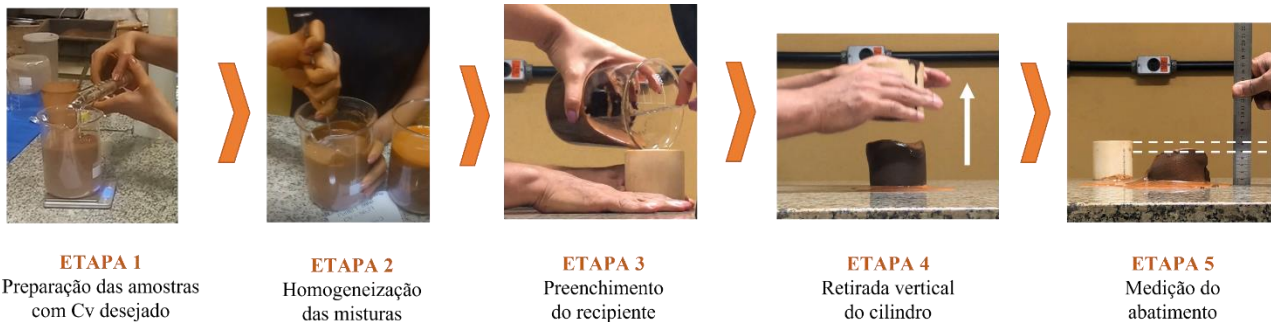
Figura 5. - Etapas da metodologia dos testes de slump realizados
