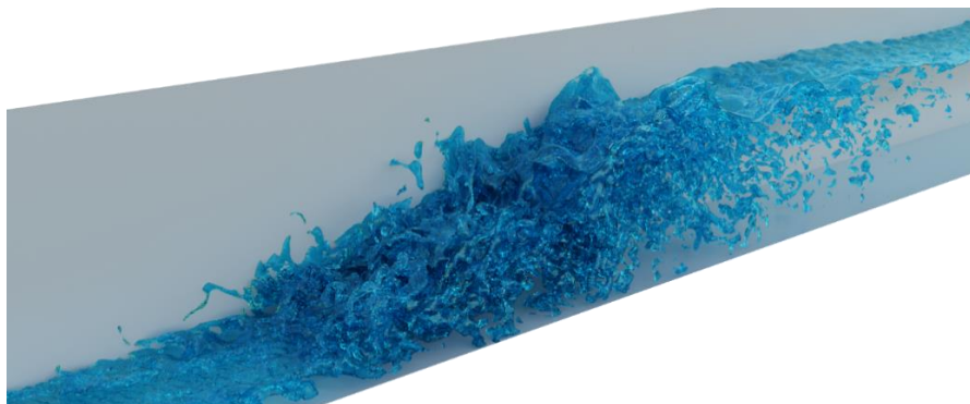
Figura 5. - Ressalto hidráulico - OpenFOAM
