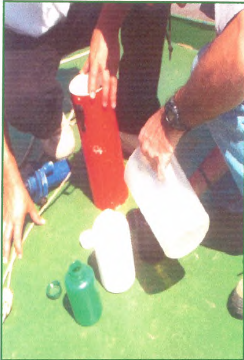
Fotografia 4.1 - Coletor de água Van Dorn e recipientes para fixação do material. Local: Pacheca, microbacia da Ilha do Vianez
