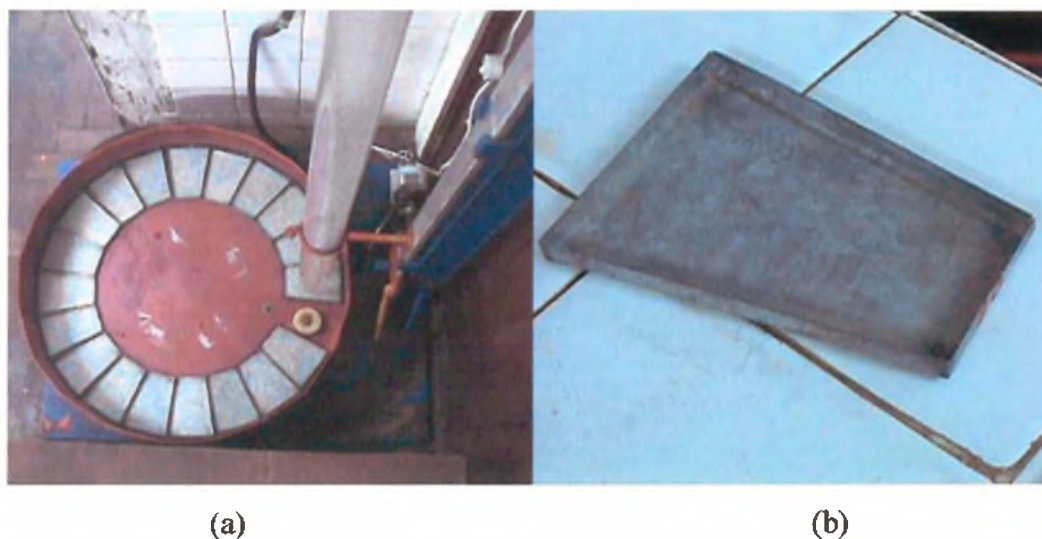
Figura 4.5. Sistema de coleta, a) Bandeja maior giratória com recipientes de coleta e b) detalhe do recipiente de coleta.
