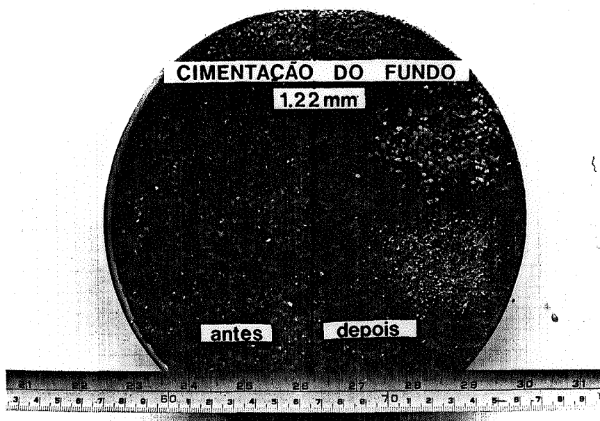
FIGURA 3.8 - Amostra do fundo antes e depois da cimentação e os dois sedimentos injetados (0,77 e 1,98mm).
