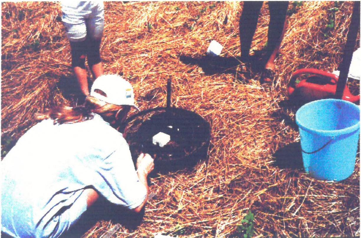
Fig. 5.7 - Monitoramento da velocidade de infiltração usando os cilindros concêntricos
