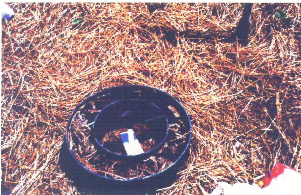
Fig. 5.6 - Anéis concêntricos instalados e parcialmente preenchidos com água
