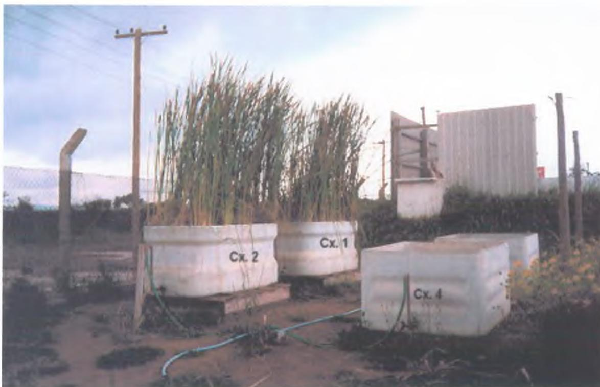
Figura 3.3 - Banhados construídos estabelecidos e controles (*Typha subulata*) após 3 meses de alimentação com efluente doméstico.
