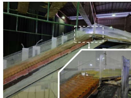
Figura 3 – Modelo físico reduzido da escada estudada.
