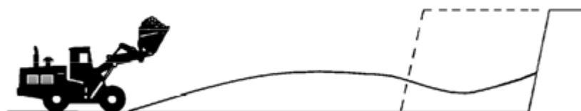
Figura 49. Modelo de pilha de material desmontado.
